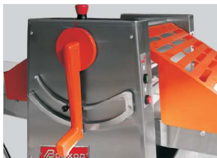
Регулировочная рукоятка с храповым механизмом, нониусом, упором. "РОЛЛ-АВТО" и "РОЛЛ-АВТО мини"
