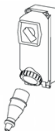
Fig. 6.2.2. - Выключатель цепи электропитания отключен
